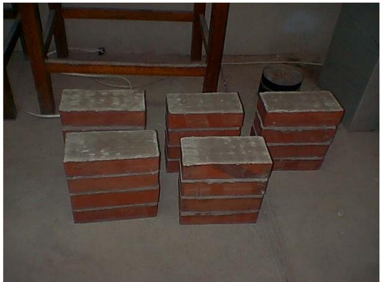
FIGURA FC4-1. FOTOS DEL ENSAYO DE COMPRESIÓN SIMPLE
