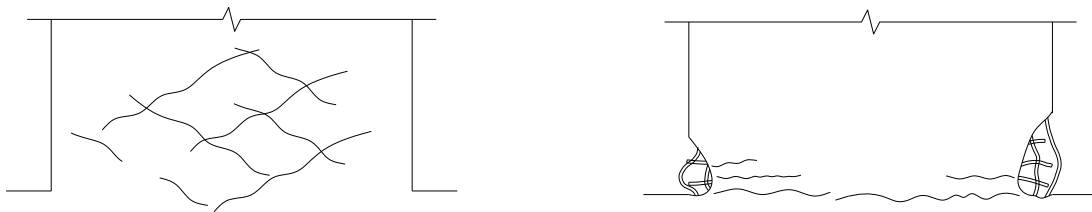
a) Grietas diagonales
